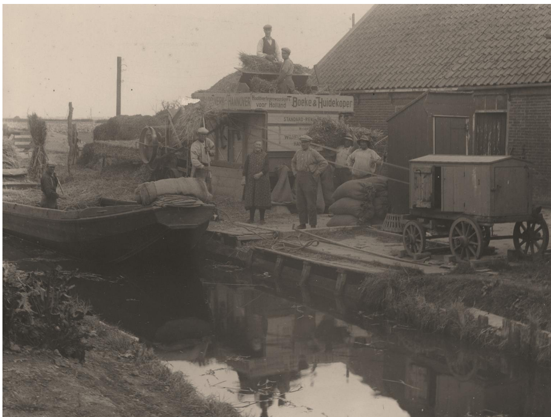
Dorsmachine Standard-Rekord van Standardwerk Wilhelm Schulze in Hannover, met een aangever in de schuit, een opsteker op de kade, een aangever boven op de machine, een insteker op de machine, de strodrager, de zakkenman en de machinist
